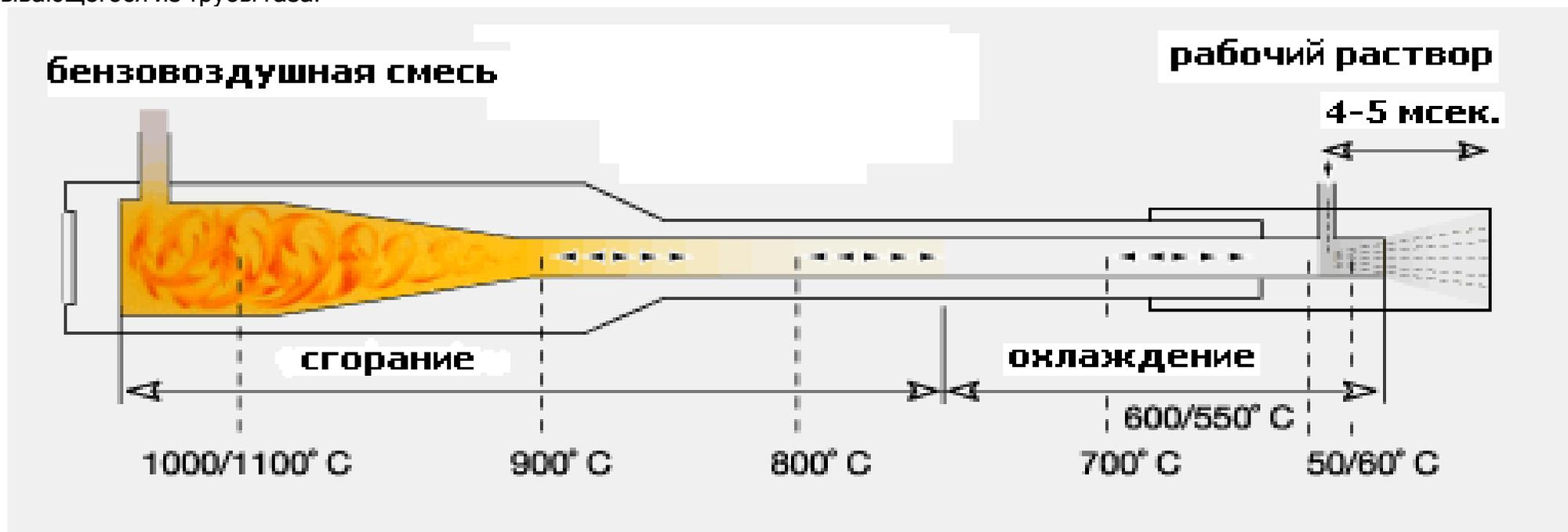
ГГТ могут работать как с растворами на основе масел с высокотемпературной точкой воспламенения, так и с водными растворами. Поскольку раствор впрыскивается в газовый поток на расстоянии 5 см от среза выпускной трубы и действующее вещество химиката подвергается воздействию высокой температуры лишь долю секунды, то все его свойства остаются неизменными.
